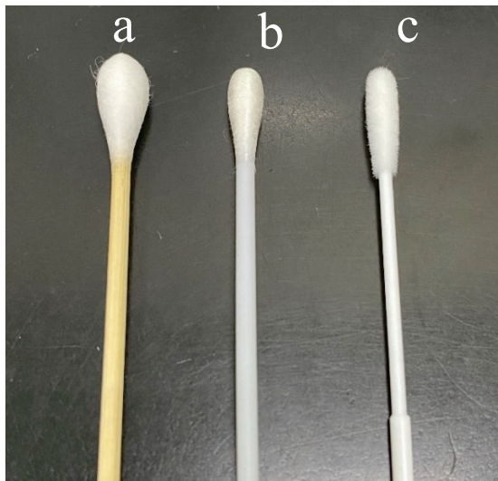
圖 1. 用於測試的三種拭子類型的外觀 a，棉花拭子(cotton swab)；b，人造絲拭子(rayon swab)；c，尼龍植絨拭子(nylon-flocked swab)
